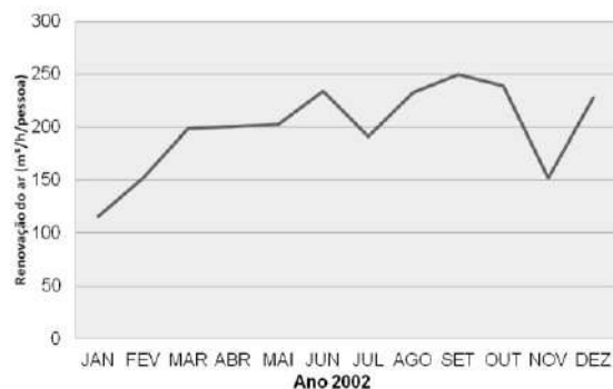
GRÁFICO 17: Renovação do ar (m 3 /h/pessoa) para a circulação do pavimento tipo proposto
