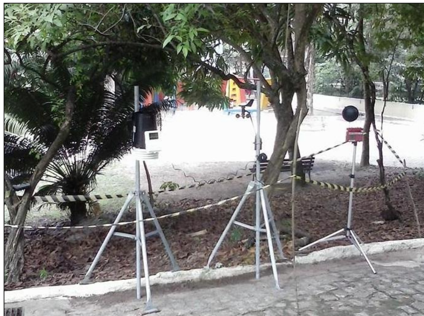
Figura 5- Equipamentos TGD-300 e DAVIS montados no ponto de coleta.
